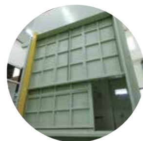
風雨試驗設備
